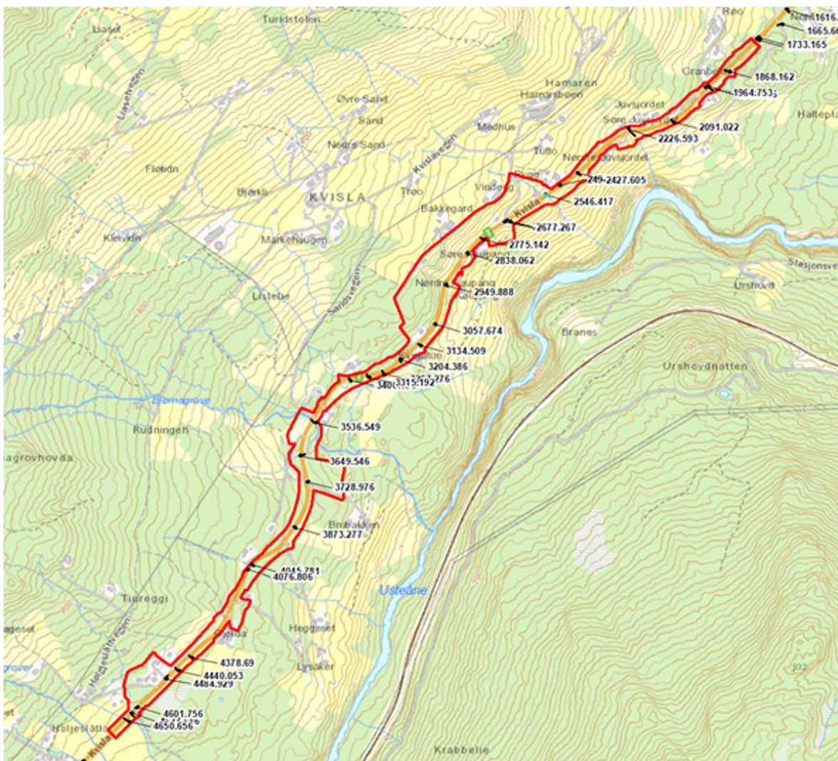
Figur 5. Kulverter langs traseen mellom Vindeggleet og Veslehaug, nummeret med veiprofilnummer/løpe m. Rød heltrukket linje viser plangrense for utbedring av strekning for Rv. 7. Kilde: ArcMap/Rambøll
